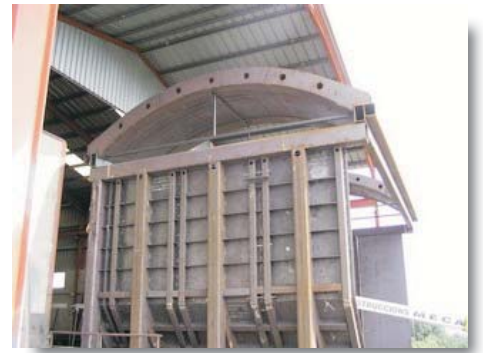
New head presentation in the work-shop before being supplied to the factory / Presentación del nuevo cabezal en taller antes de su envío a fábrica
